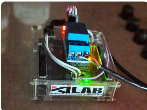
Gambar 9: Perangkat elektronik pembangkit detik bintang digital
