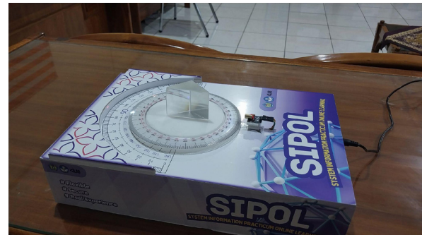
Gambar 3: Perangkat Laboratorium pembiasan cahaya pada prisma
