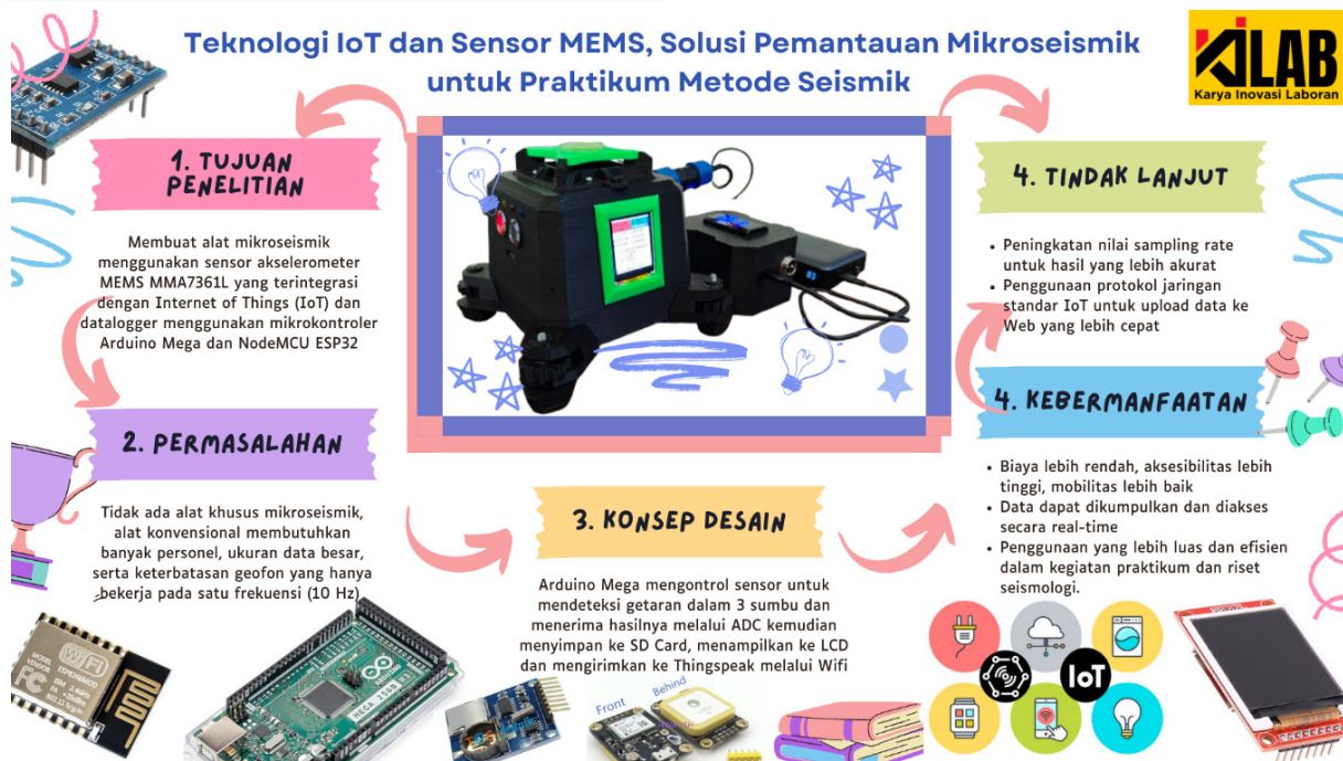
Gambar 1: Infografis teknologi dan sensor MEMS.
